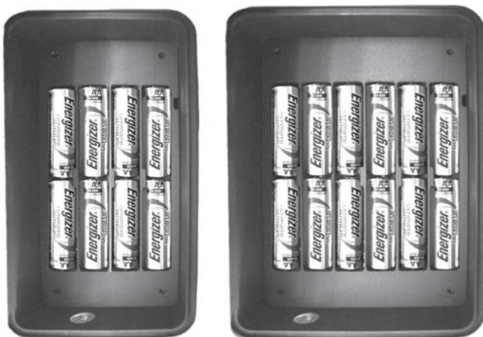
Мы рекомендуем использовать полный набор новых литиевых аккумуляторов типа AA компании Energizer или щелочные аккумуляторы типа AA. Мы не рекомендуем никель-металгидридные перезаряжаемые аккумуляторы, так как низкое выходное напряжение может вызвать некорректное выполнение отдельных операций.
